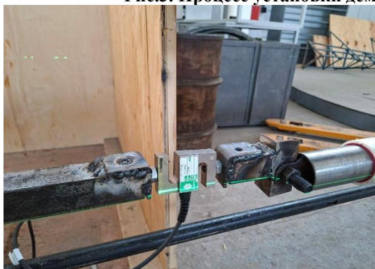
Рис.4. Установка датчика силы и перемещения демпфера
