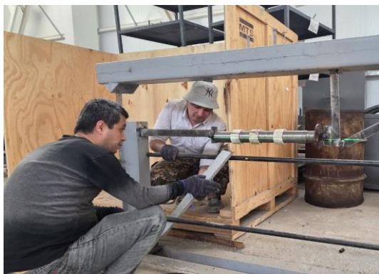
Рис.3. Процесс установки демпфера на испытательный стенд
