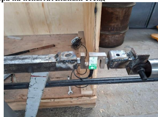
Рис.4. Установка датчика силы и перемещения демпфера
