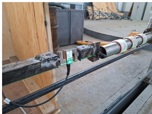
Рис.3. Процесс установки демпфера на испытательный стенд
