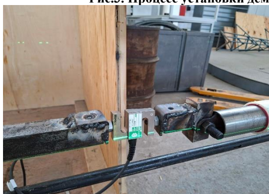
Рис.4. Установка датчика силы и перемещения демпфера
