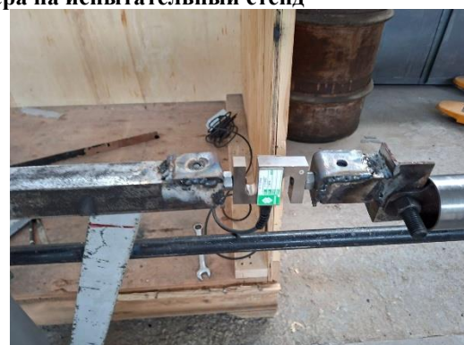
Рис.4. Установка датчика силы и перемещения демпфера
