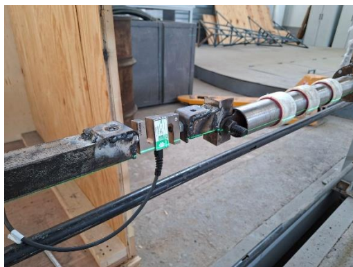
Рис.3. Процесс установки демпфера на испытательный стенд
