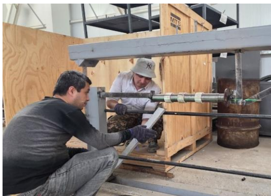
Рис.3. Процесс установки демпфера на испытательный стенд
