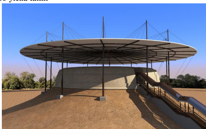
3-rasm. Chilpiq qal'aning ko'rinishi va atmosfera ta'siridan saqlash uchun konstruktiv tadbir – vantli konstruksiya
