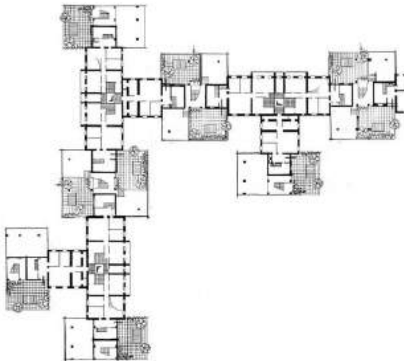
2-расм. 2-қават тархи. Пастки қаватларнинг устёпмаларида ховли-айвони бўлган бир сотхда 5, 6, 7 хонали 60 хонадонли 4 ёқаватли экспериментал турар жой уйи.
