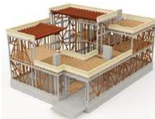
1-rasm. Sinch devorli uy qurilishi ketma-ketligi va konstruksiyasi
