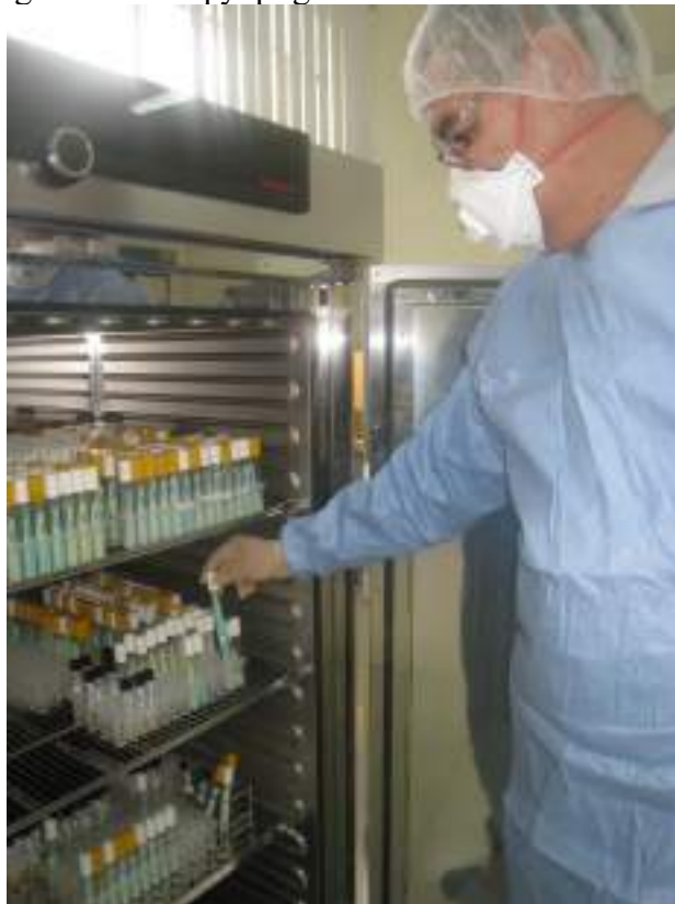
2-rasm. Biologik namunalarni inkubatsiya qilish uchun laboratoriya quruq havo inkubatori (termostat) Memmert IN750. Rasmda Mycobacterium tuberculosis koloniyalarining o'sishi uchun Levenshteyn-Yensen ozuqa muhiti bilan sinov probirkalari ko'rsatilgan.
