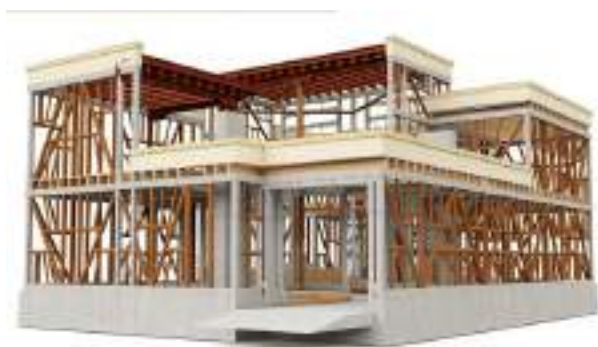
2-rasm. Xivadagi sinch konstruksiyali turar joy binosining konstruktiv yechimi.
