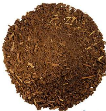
4-расм. Таъмирланаётган бинонинг ostki qatlam uchun “LEHM UNDER PUTZ” маркали сомонлойли яримтайёр маҳсулот
