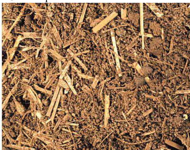
3-расм. Таъмирланаётган бинонинг ustki qismi uchun “LEHM OBER PUTZ” маркали сомонлойли яримтайёр маҳсулот
