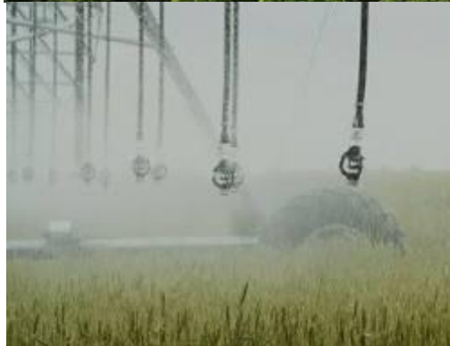
19-rasm. Aerozol (tumanlatib) sug'orishning dala sharoitida ishlatilishi.
