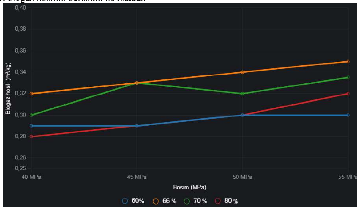
1-rasm. Biogaz hosili va bosim o'rtasidagi bog'liqlik
