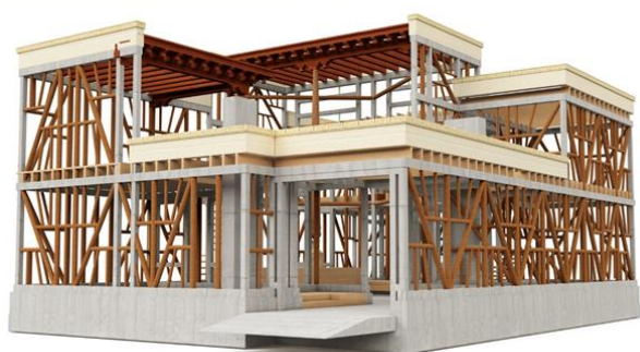
2-rasm. Xivadagi sinch konstruksiyali turar joy binosining konstruktiv yechimi.
