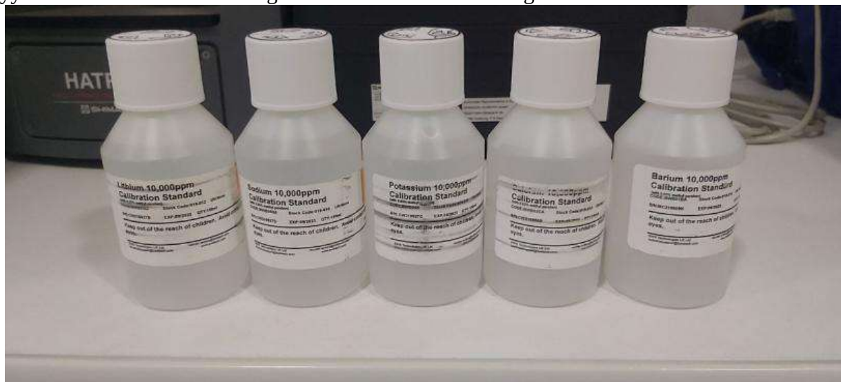
1-rasm. Ishqoriy va ishqoriy yer metallarining standart eritmaları Li, Na, K, Ca, Ba. BWB xp Technologies UK Ltd
