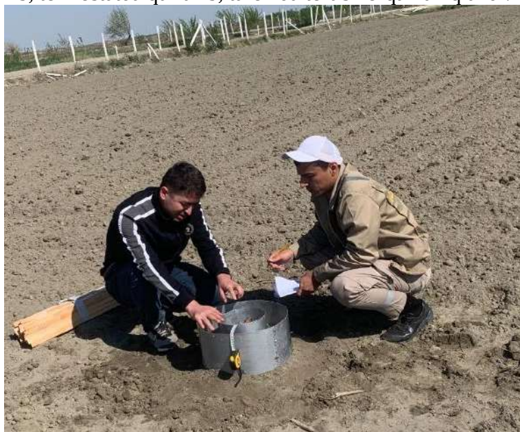
1-rasm. Tuproqning suv o'tkazuvchanligini aniqlash jarayoni
