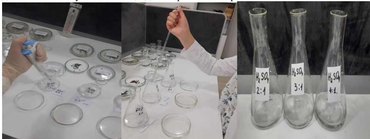
3-расм. Сульфат кислотанинг турли нисбатлари 2:1, 3:1, 4:1.Дозатор пипетка ва шиши тайокчадан фойдаланган ҳолда \text{H}_2\text{SO}_4 нисбатларини тайёрлаш
