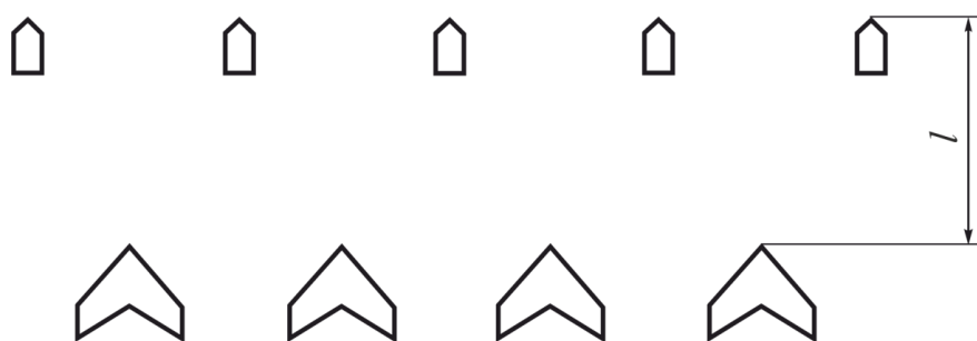
2-расм. Юмшаткич ва ўқёйсимон панжалар орасидаги бўйлама масофа
