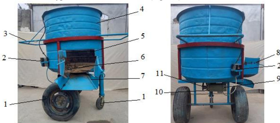
1-расм. Дағал озуқаларни тарқатиш қурилмасининг тажриба нусхаси
