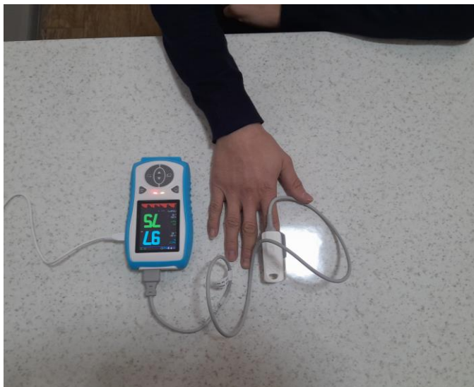
6-rasm. Qo'l pulsoksimetri PRMISEMED PRO-PM350 yordamida ko'ngillilarda SpO_2 miqdorini o'lchash
