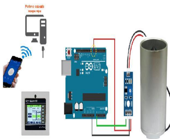
5-расм. Гидропоника усулида яшил озуқа етиштириш тизимини автоматлаштиришнинг тузилмаси
