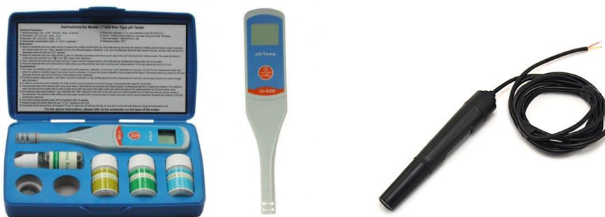
2-расм. а) QY-620 русумли pH – ўлчагичнинг умумий кўриниши б) Электр ўтказувчанлик датчиги
