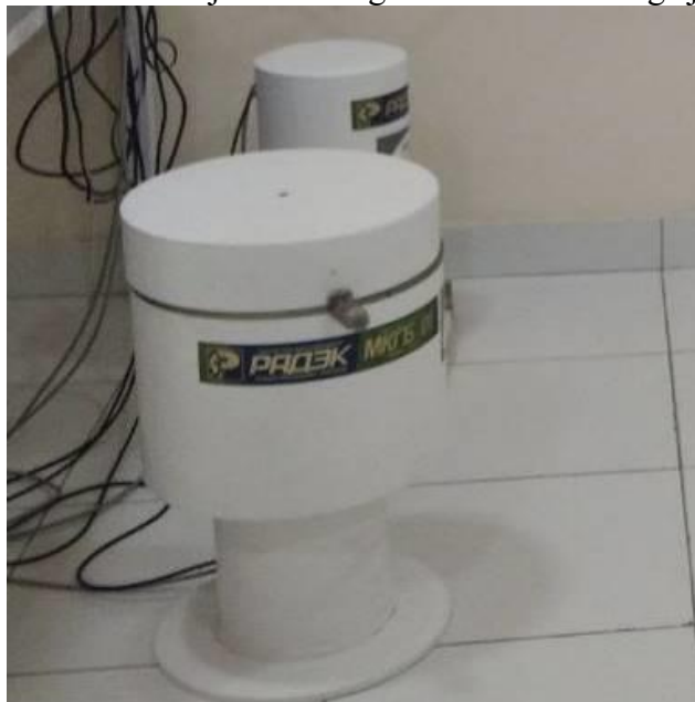
1-rasm. Ssintillyatsion gamma-spektrometr (RADEK) qurilmasi yordamida lishayniklar tarkibidagi radionuklidlar tarkibini aniqlash
