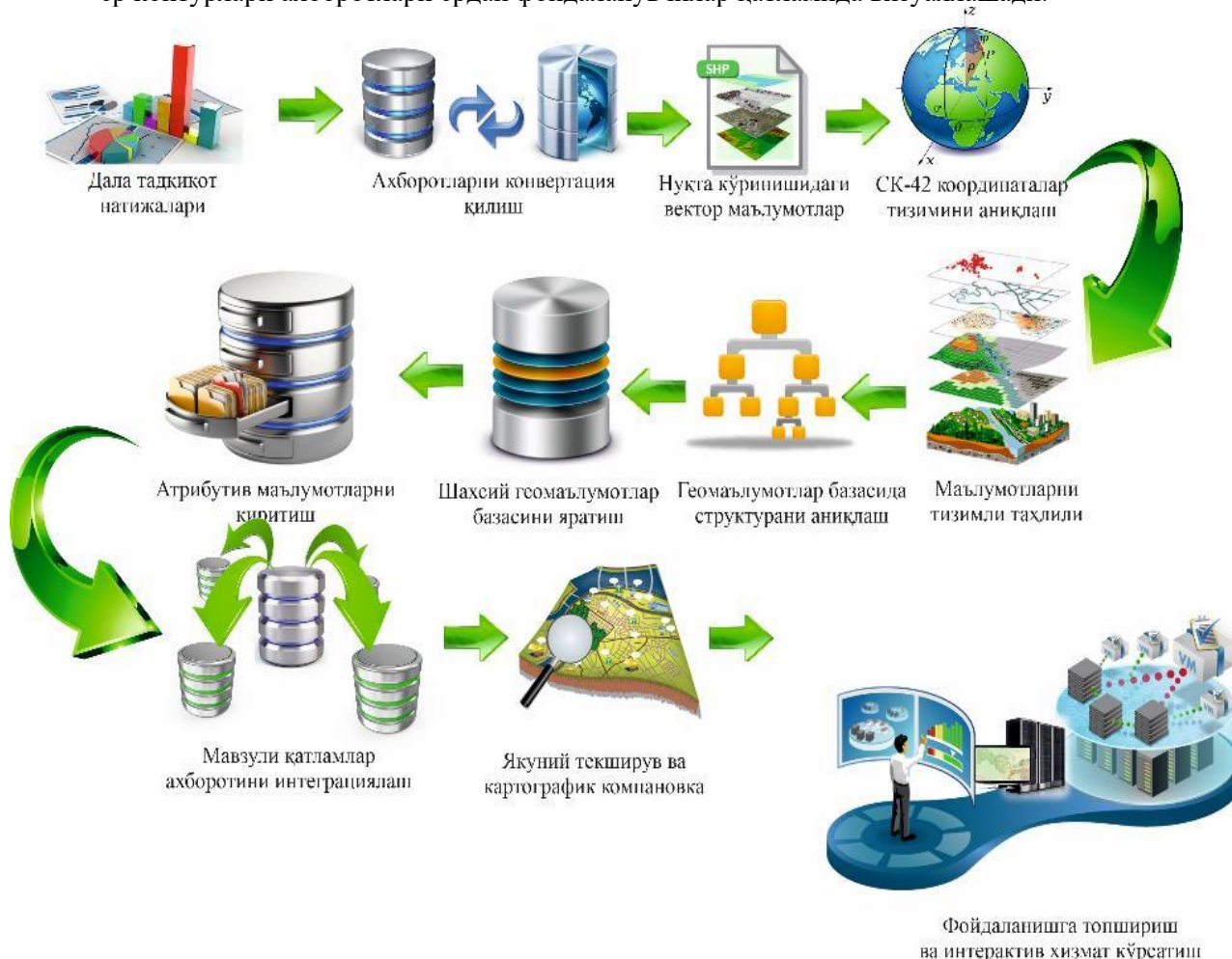
1-расм. Маълумотларни тўплаш ва уларни геомаълумотлар базасига интеграциялаш схемаси
