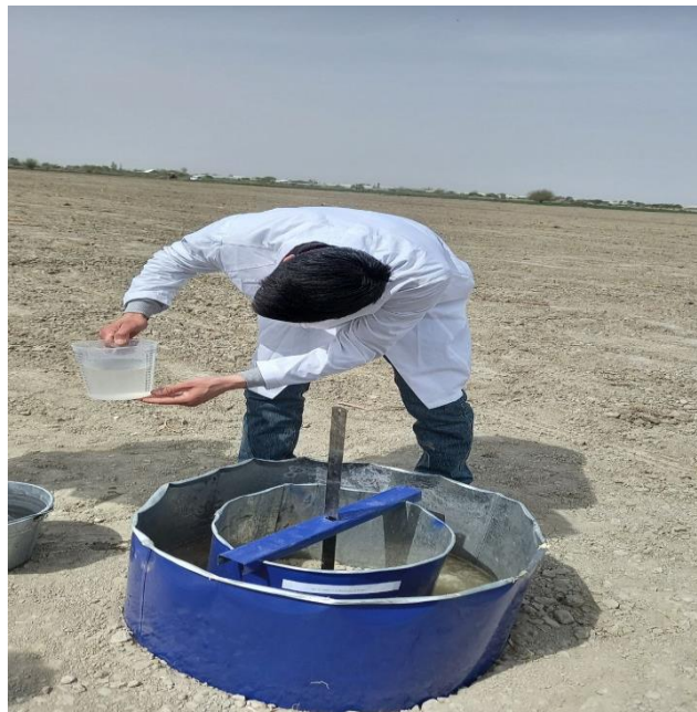
1-rasm. “Muhammad Choriqiy” fermer xo'jaligi soya ekiladigan dala maydonida, tuproqning suv o'tkazuvchanligini aniqlash jarayoni
