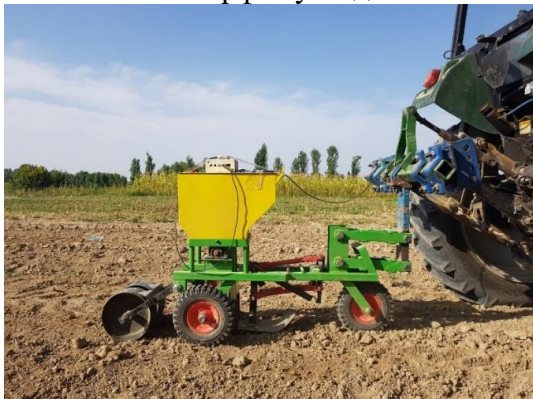
1-расм. Пахта чигити билан соя уруғини бир вақтда экувчи сеялка секциясининг қаршилиғини аниқлаш ҳолати
