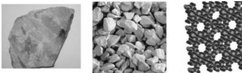
Рис. 1. Внешний вид цеолита и его микропористая структура
