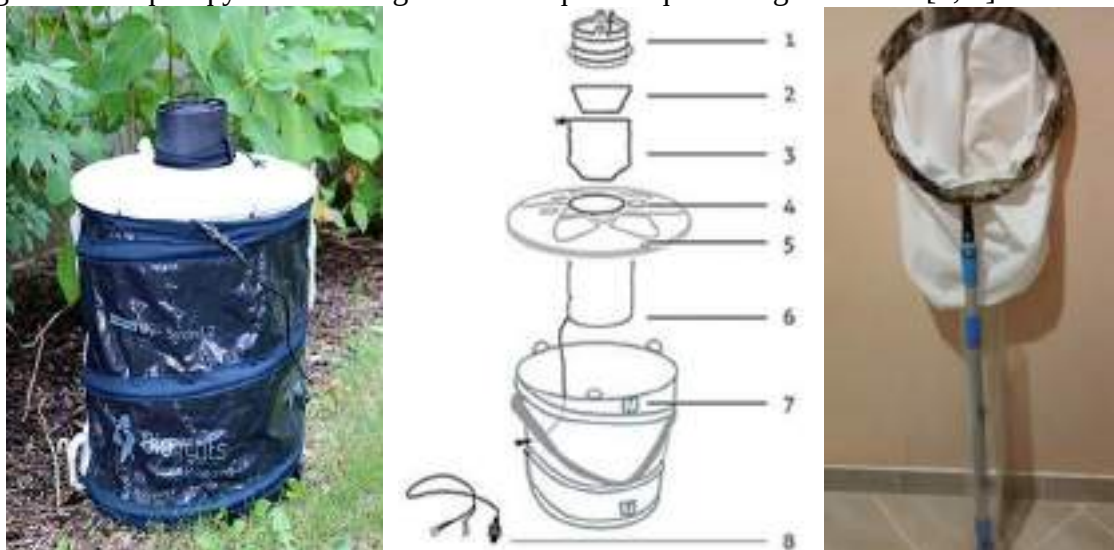
1-rasm. BG Sentinel tuzoqning umumiy ko'rinishi va qismlari (1) Hasharotlarni so'rish (o'tkazish) voronkasi, (2) to'r voronka, (3) tutqich qop, (4) BG-Lure uchun o'tkazish teshigi, (5) oq qopqoq, (6) ventilyator, (7) batareya kabeli
