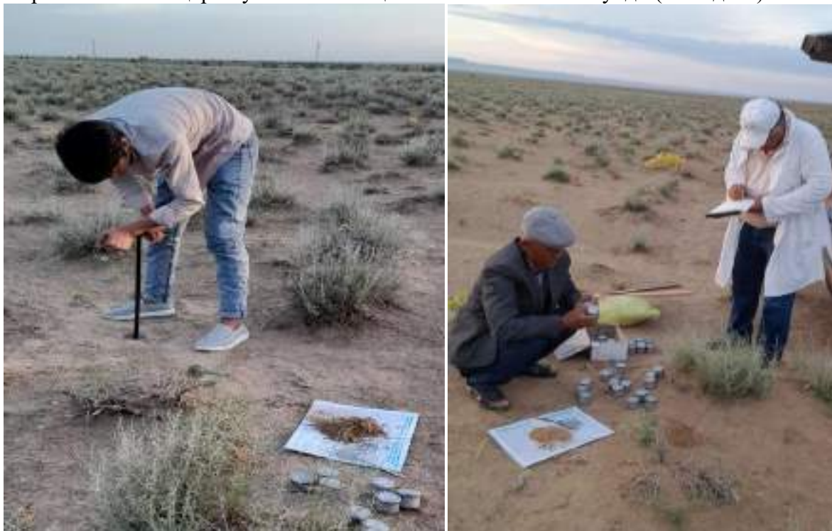
2-расм. Конимех туманининг кумли чўл яйловлар тупроғидаги намлигини аниқлаш.
