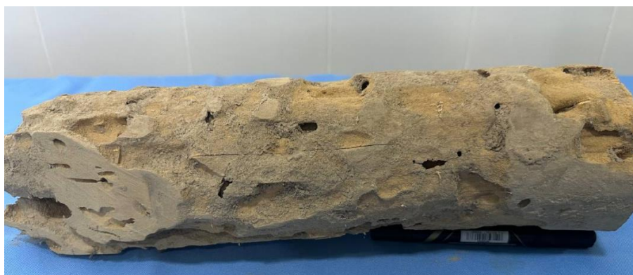
3.5.1-rasm. Termit tomonidan zararlangan yog'och bo'lagi: quruq yog'ochda termitlari tomonidan hosil qilingan galereyalar. (Original rasmlar)
