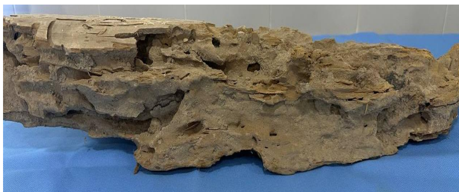
3.5.2-rasm. Termit tomonidan zararlangan yog'och bo'lagi: yer osti va devor orasidagi yog'ochning termitlar tomonidan zararlanishi. (Original rasmlar)
