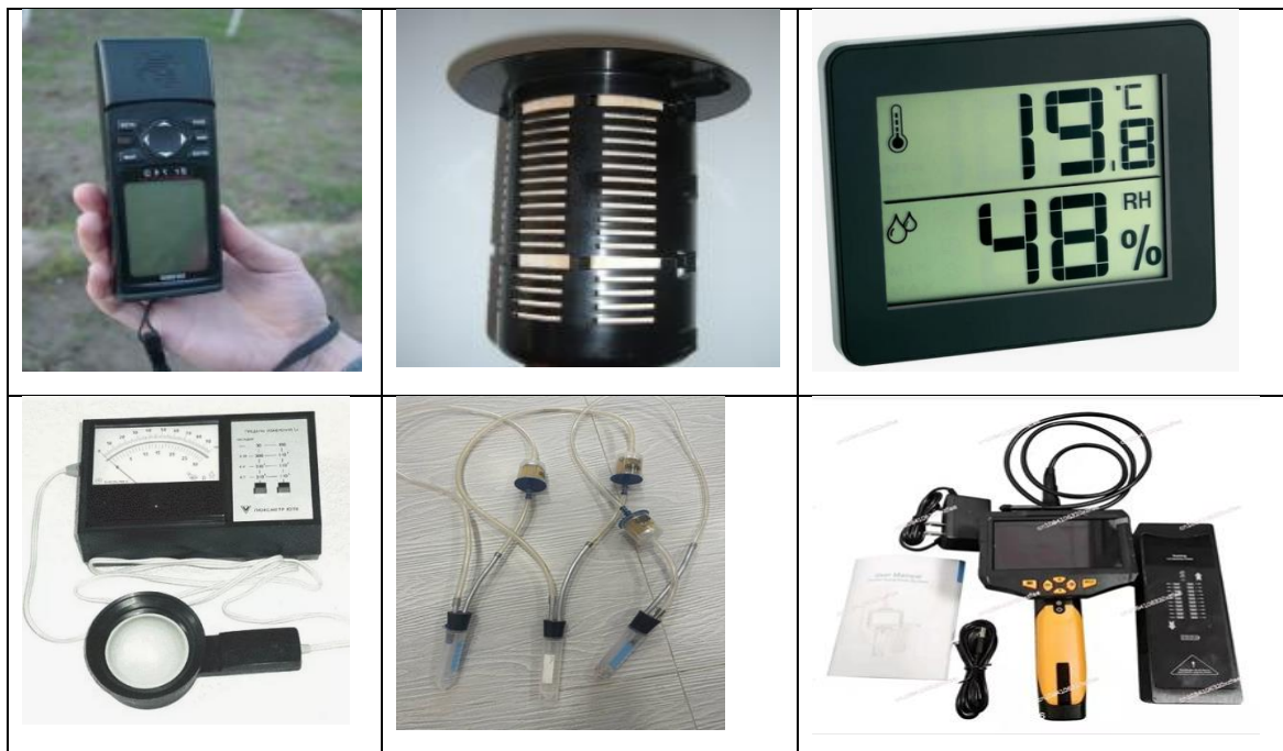
2.2.1-rasm. Termitlar faoliyatini aniqlashda foydalaniladigan asboblari (yuqoridan boshlab chapdan qarab o'ngga GPS, Eksterra, termometr, lyuksimetr, eksgauster, raqamli tekshirish tizimi (Original rasmlar.)
