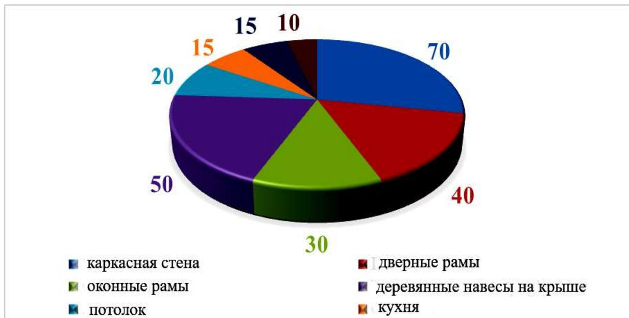
**Рисунок 5.** Повреждение частей дома в результате нападения рабочих термитов (цифры в показателе нападений)
